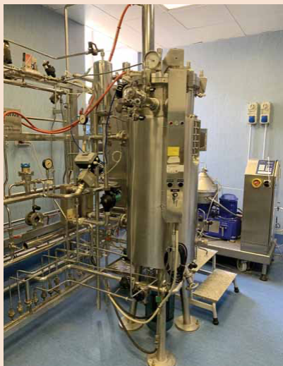
Formentatore da 500 litri per la messa a punto di processi pilota di produzione in ambito biofarmaceutico
